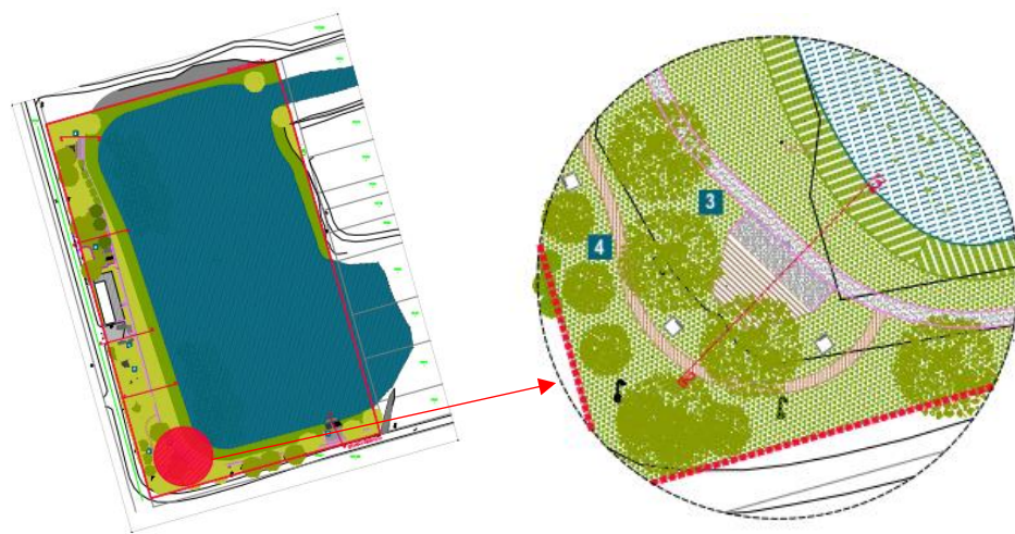
Slika 7. Primjer presjeka na poziciji odmorišta i uređenja pješačke staze i hortikulturnog oblikovanja na lokaciji zahvata (Izvor: Arhitektonski projekt, 2025.)
