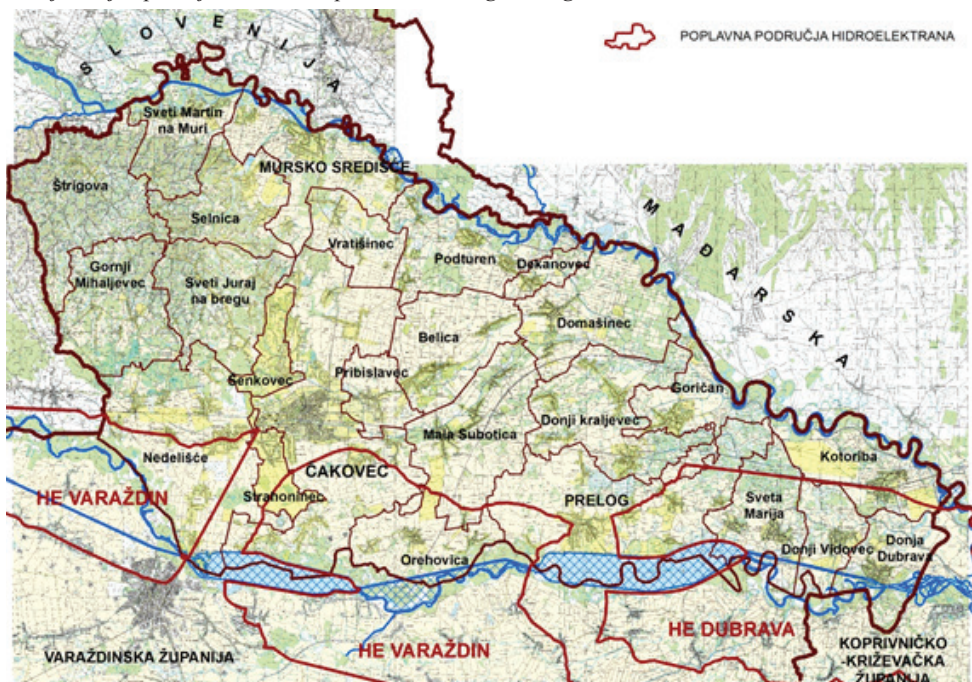
Slika 15. Ugrožena područja uslijed proboja brane i nasipa na hidroenergetskim građevinama
